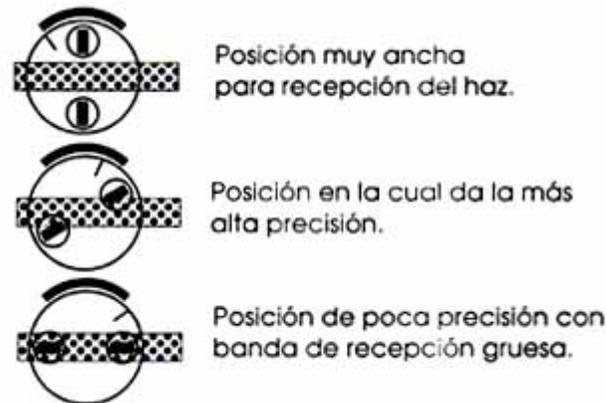
Es importante comprender que el **ROD EYE-5** no está diseñado para trabajar solamente con el **LB-5 MINI BEACON**, sino con cualquier láser rotante que tiene el diámetro del haz más grande. Por esta razón, la mayoría de las calibraciones de las fotoceldas no son necesarias cuando se usa con el **LB-5**.
