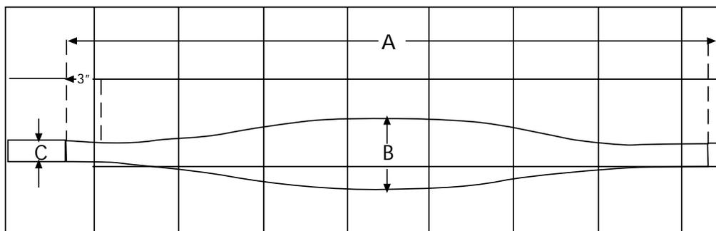
Usando la plantilla, se trazan y cortan los contornos de los casquetes sobre el PIPE WRAP FIBERGLASS.
