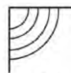
\phi=4 Radiación uniforme sobre 1/4 de esfera
