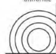
\phi=8 Radiación uniforme sobre 1/8 de esfera
